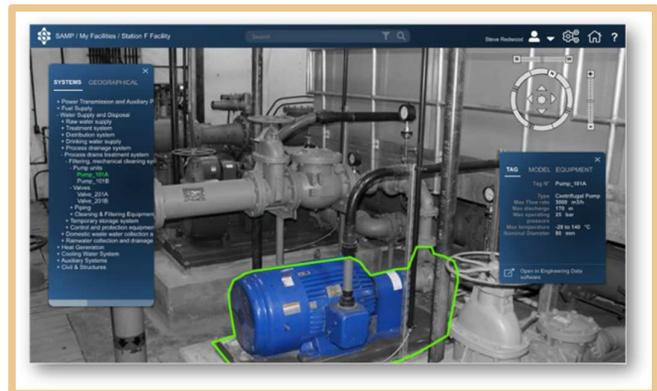
Véritable « Jumeau Numérique 3D » de l'installation, la solution de Samp augmente l'efficacité des chantiers neufs en automatisant la validation du *Tel Que Construit* par rapport au *design* tout en i) structurant les activités d'inspection / maintenance et en ii) réduisant significativement la durée des grands arrêts grâce une préparation optimale.
