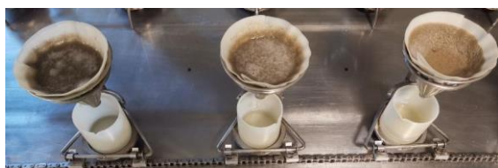
Image 1 : Observation de la quantité de filtrat et de la vitesse de filtration.
