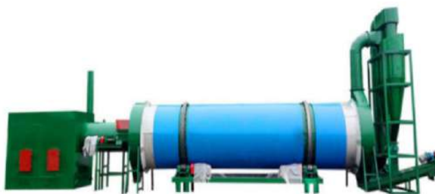
Image 2 : Four tambour sécheur à multiples passages cyclone
